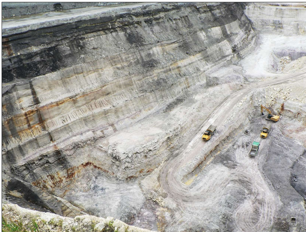
Pohled k JZ dolu na ložisko pod jižní stěnou lomu Babín-sever. Báze křídý a profil v karbonu: nýřanské vrstvy, svrchní lávka ložiska, výkliz pískovcového proplástku a zcela vpravo dole dílčí řezy ve spodní lávce ložiska. Bagr je pod tektonickým zlomem (srpen 2021).
